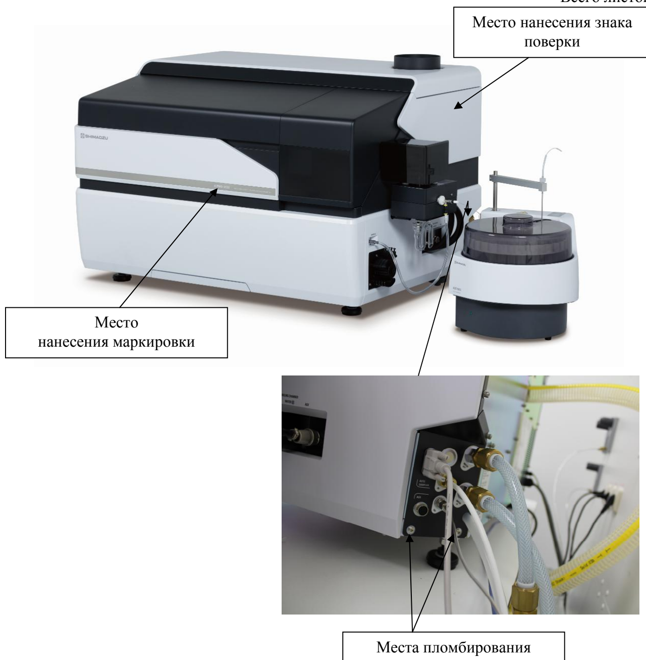
Рисунок 1 - Общий вид Масс-спектрометров с индуктивно-связанной плазмой ICPMS-2030 с обозначением мест нанесения маркировки, знака поверки и пломбирования
