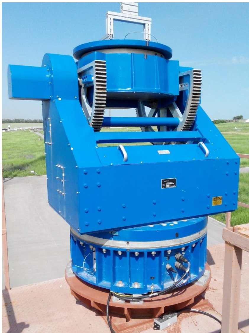
Рисунок 4 - Внешний вид ОПУ AL-4507-1
