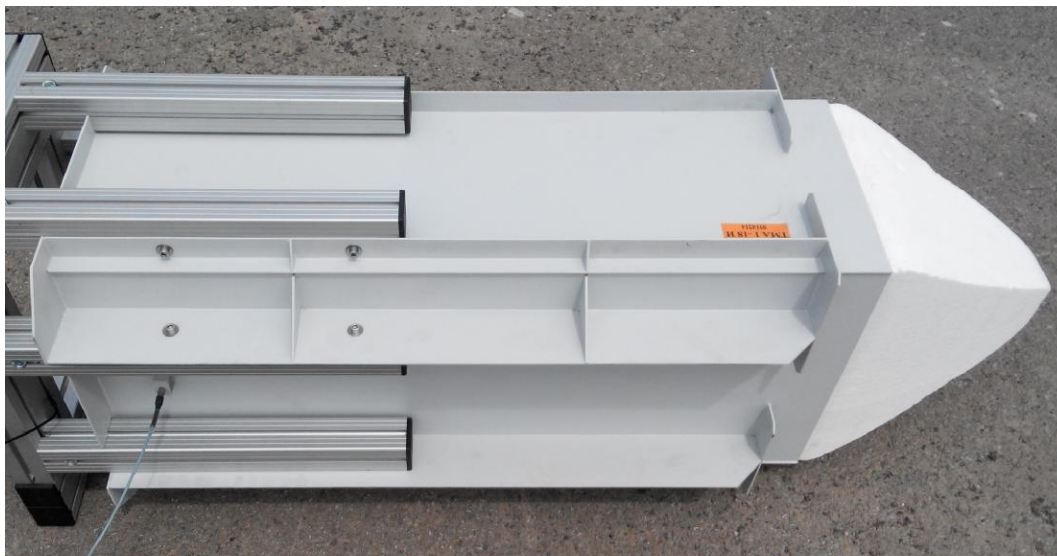
Рисунок 2 - Внешний вид вспомогательной антенны ТМА 1-18 И
