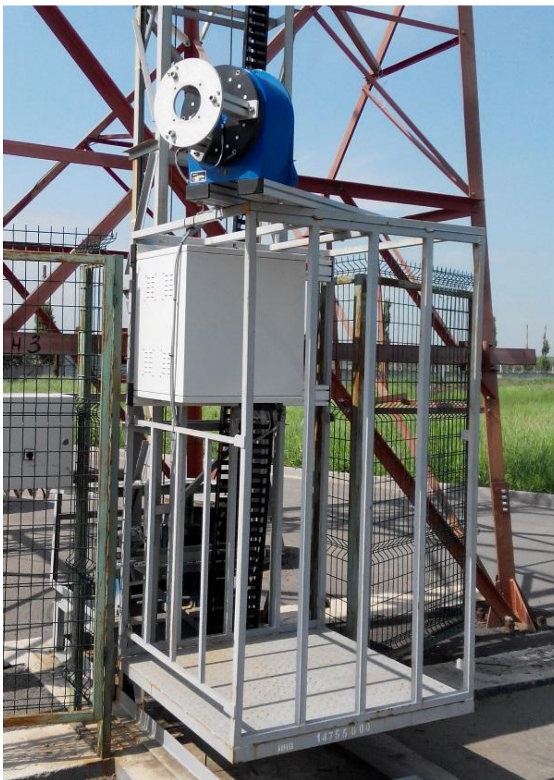
Рисунок 5 - Внешний вид подъемного устройства с поляризатором вспомогательной антенны AL-560-1
