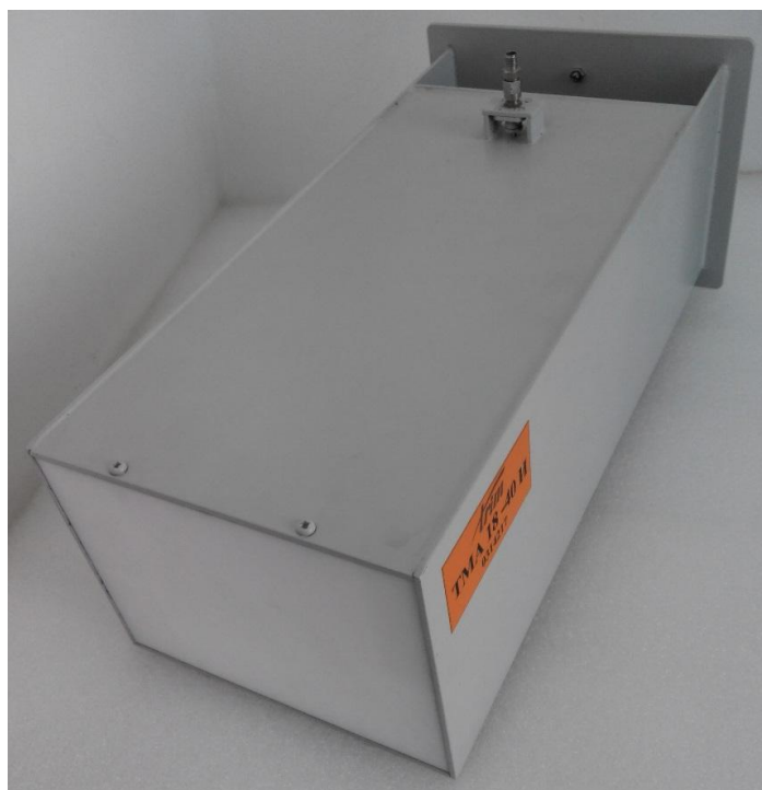
Рисунок 3 - Внешний вид вспомогательной антенны ТМА 18-40 И
