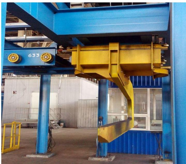
Рисунок 1 - Общий вид весов товарные встроенные SUNDCO H
