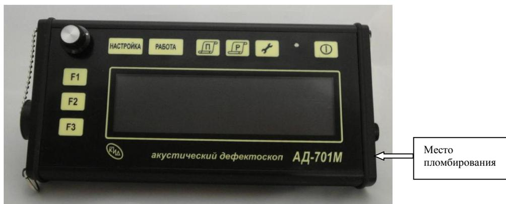
Рисунок 1 - Внешний вид передней панели электронного блока
