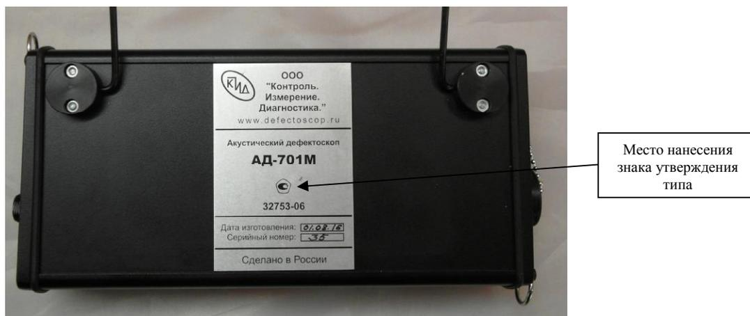
Рисунок 2 - Внешний вид задней панели электронного блока
