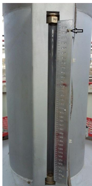
Рисунок 2 - Схема пломбировки от несанкционированного доступа, обозначение места нанесения знака поверки установки поверочной средств измерений объема и массы УПИМ-2000
