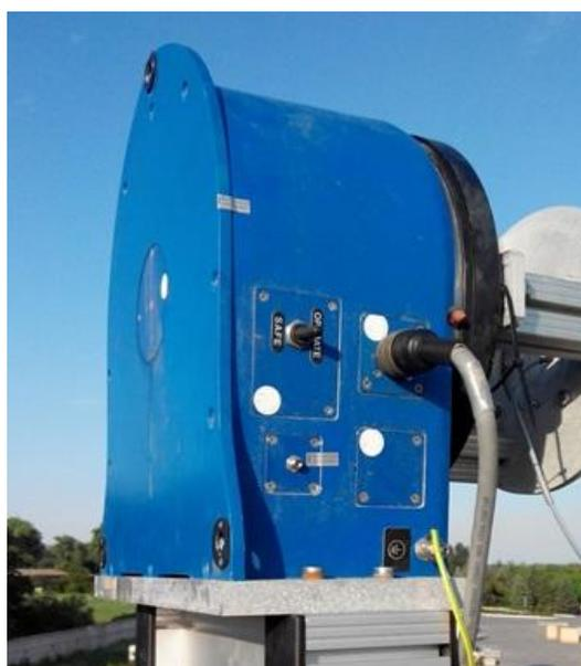
Рисунок 5 - Внешний вид поляризатора вспомогательной антенны AL-560-1
