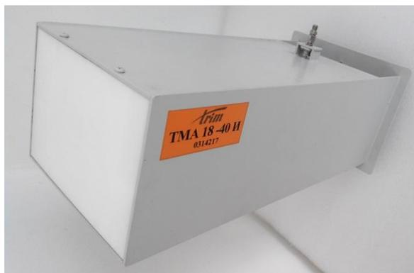
Рисунок 3 - Внешний вид вспомогательной антенны ТМА 18-40 II
