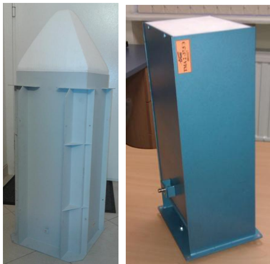
Рисунок 9 - Внешний вид эталонных антенн диапазона частот свыше 3 ГГц
