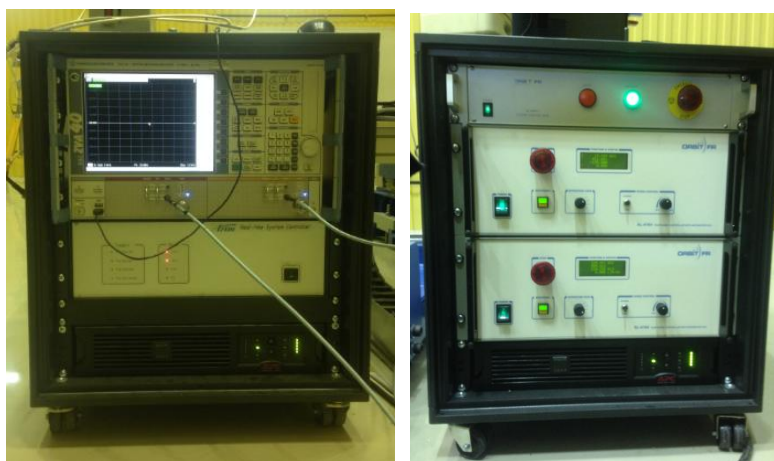
а) векторный анализатор цепей в стойке б) контроллеры
