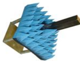
Рисунок 7 - Внешний вид антенны-зонда диапазона частот от 18 до 40 ГГц
