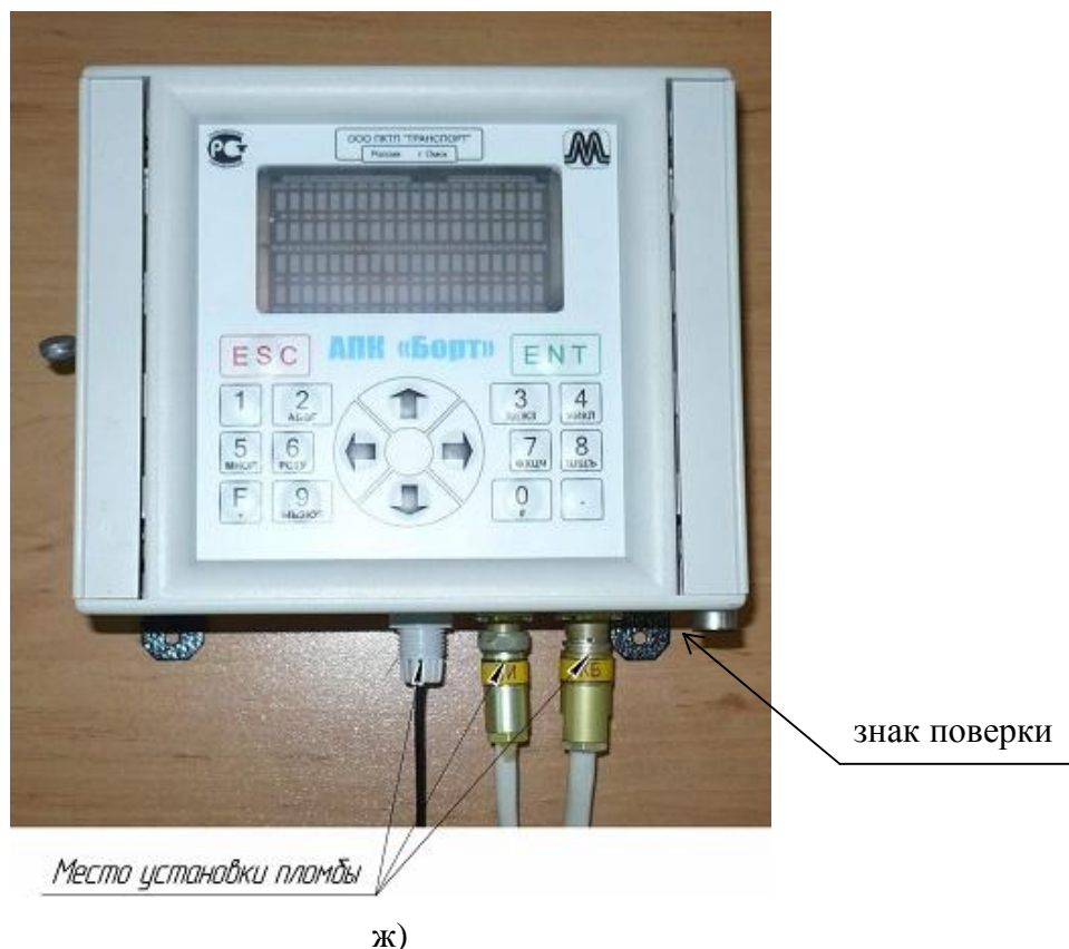
Рисунок 2 - Схема пломбировки от несанкционированного доступа, обозначение нанесения знака поверки
