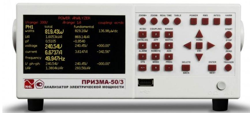
Рисунок 2 - Общий вид анализаторов электрической мощности ПРИЗМА 50, ПРИЗМА 150
