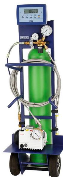
а) модификация GCS-1 с терминалом DI30 различных исполнений;
