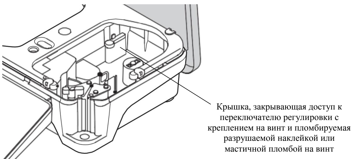
Рисунок 2 - Схема пломбировки от несанкционированного доступа (bPlus-T2...)
