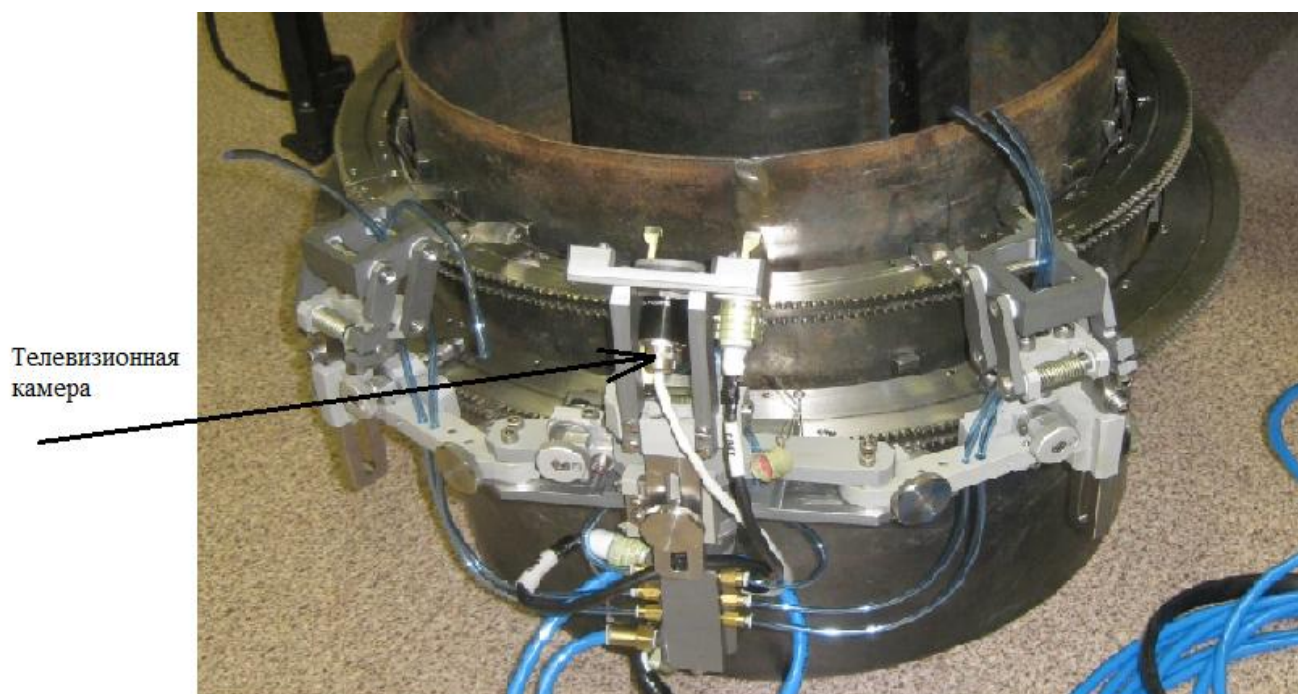
Рисунок 1 - Манипулятор комплекса КоТИК-УС с установленной на нем телевизионной камерой
