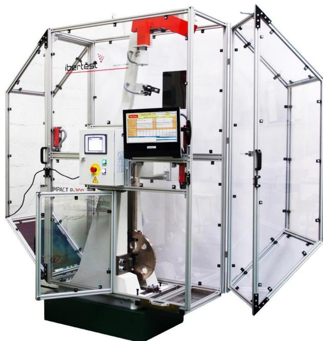
Рисунок 1 - Общий вид копров маятниковых серии Impact P
