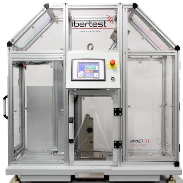
Рисунок 2 - Общий вид копров маятниковых серии Impact D
