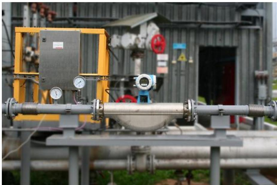
Рисунок 1 - Общий вид установки поверочной массомерной УПМ
