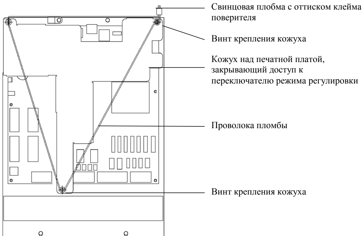
Рисунок 2 - Схема пломбировки печатной платы электронного устройства обработки измерительной информации и управления
