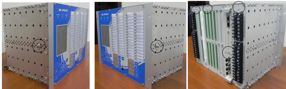
Рисунок 2 - Места пломбировок терминалов (места пломбировок отмечены кругом)
