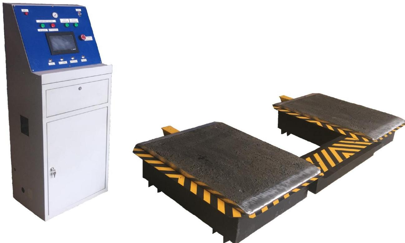
Рисунок 1 - Общий вид станда тормозного площадочного СТИП (слева - шкаф управления, справа - рабочие столы)
