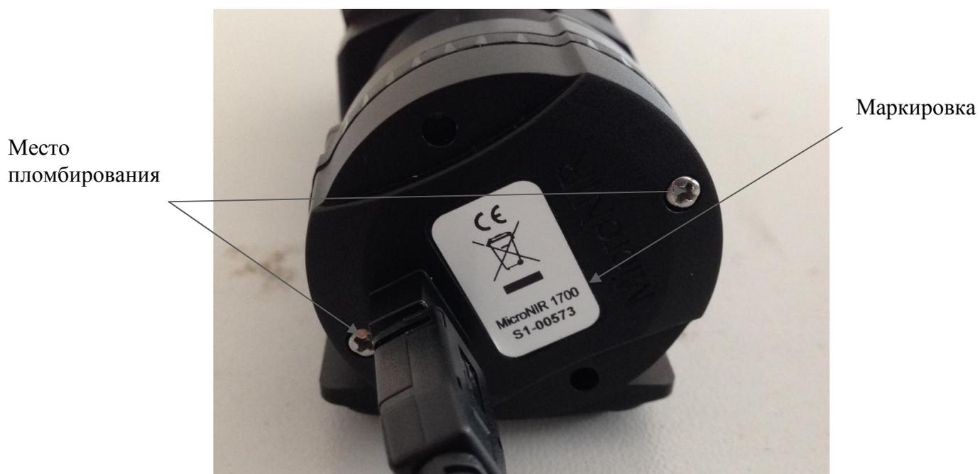
Рисунок 3 - Схема пломбировки и обозначение места нанесения маркировки
