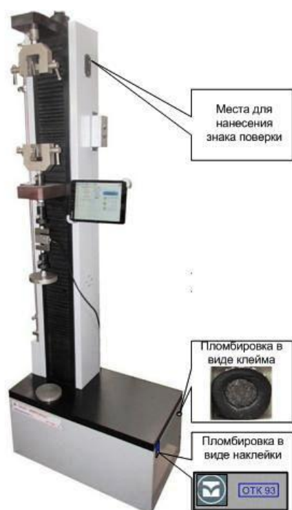
Рисунок 4 - Схема пломбировки машин исполнения ИР 5091 от несанкционированного доступа и нанесения знака поверки
