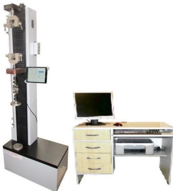
Рисунок 1 - Машины испытательные исполнения ИР 5091 модификаций ИР 5091-0,1; ИР 5091-0,5; ИР 5091-1; ИР 5091-2; ИР 5091-5; ИР 5091-10
