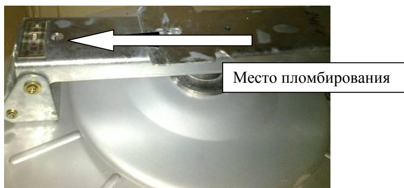
Рисунок 3 - Запорный механизм крышки заливной горловины АТЗ
