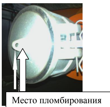
Рисунок 5 - Заглушка открывания трубопровода слива топлива из АТЗ
