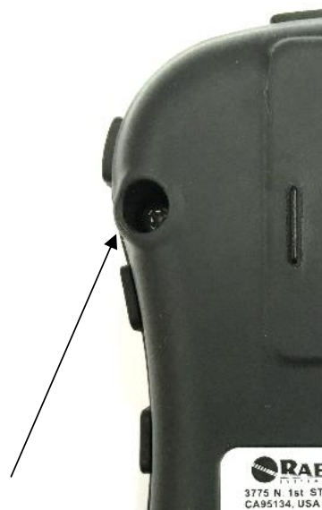
Рисунок 2 - Место пломбировки корпуса для ограничения несанкционированного доступа
