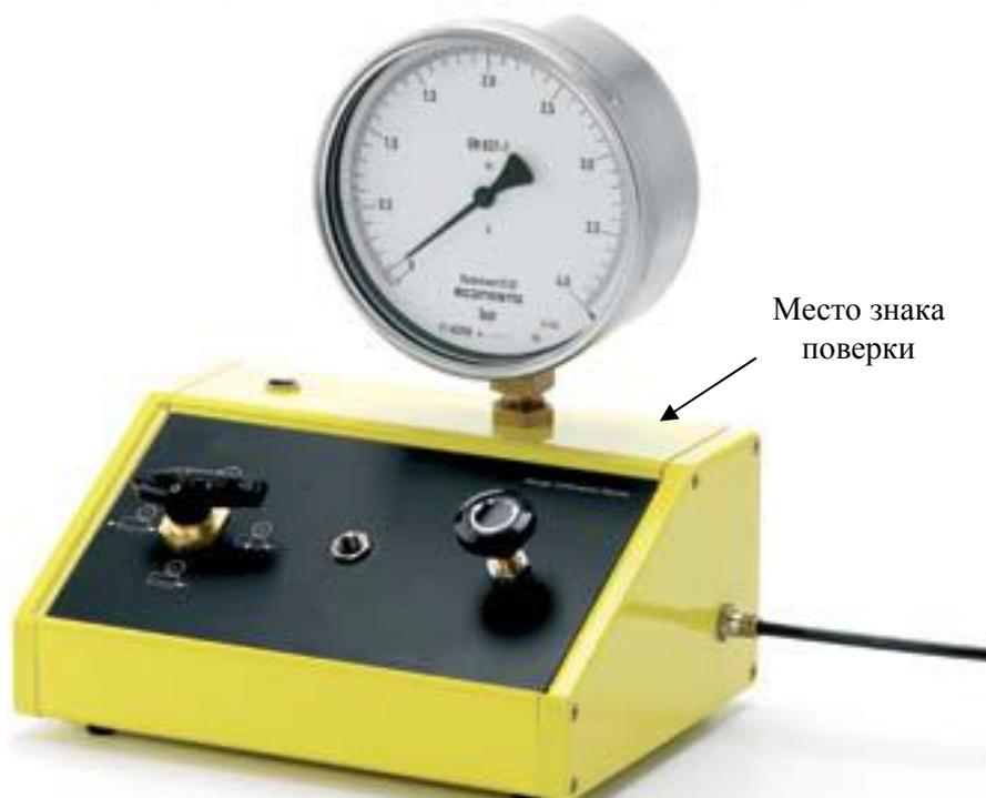
Рисунок 1 - Внешний вид калибратора давления GCD
