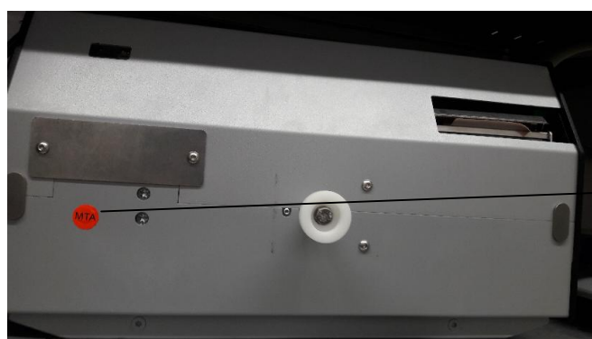
Рисунок 3 - Схема пломбировки от несанкционированного доступа средств измерений с ГПУ, подвешенным снизу корпуса
