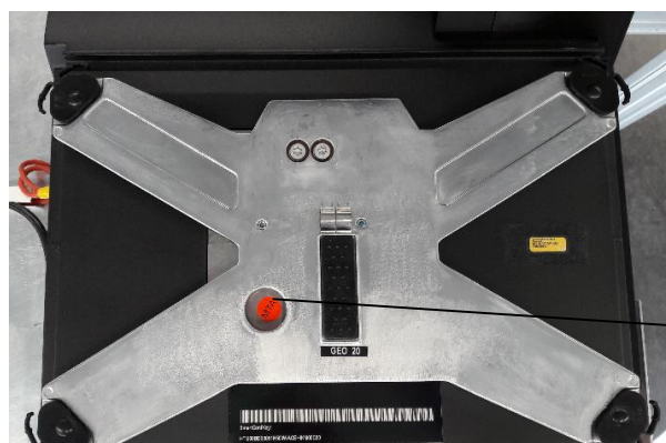
Рисунок 2 - Схема пломбировки от несанкционированного доступа средств измерений с ГПУ, объединенным в одном корпусе с электронным устройством
