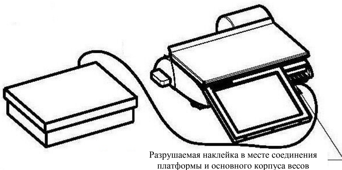
Рисунок 4 - Схема пломбировки от несанкционированного доступа средств измерений с ГПУ в виде отдельной платформы
