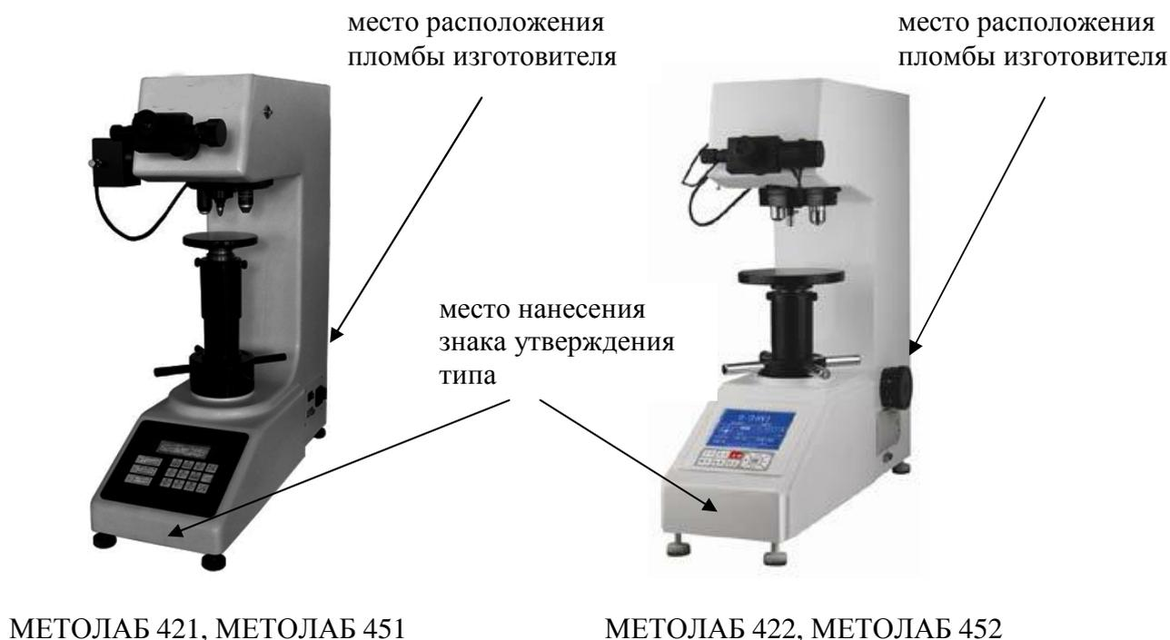
Рисунок 1 - Внешний вид твердомеров
