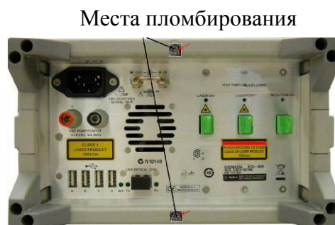
Рисунок 2 - Задняя панель и места для пломбирования анализаторов цепей векторных N5225A с блоками оптического удлинения портов U3020AY03 и U3020AY04
