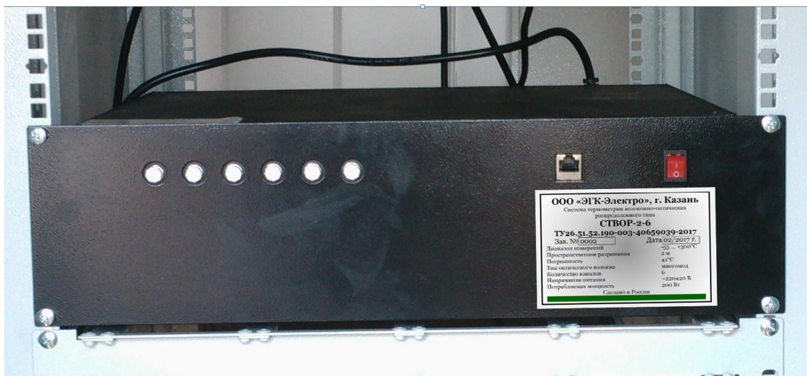
Рисунок 1 - Общий вид 6-ти канального блока опроса системы (лицевая сторона)
