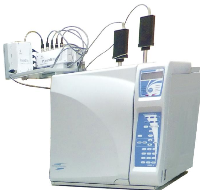
Рисунок 2 - Общий вид хроматографа «Кристалл 5000»
