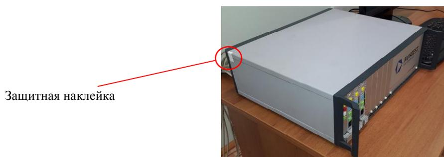
Рисунок 3 - Схема нанесения защитной наклейки от несанкционированного доступа
