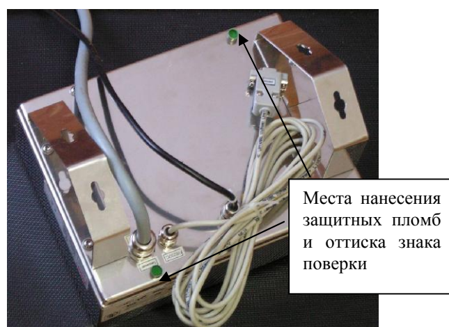
Рисунок 2 - Внешний вид дискретного отсчётного устройства типа SE и схема пломбирования весов от несанкционированного доступа.
