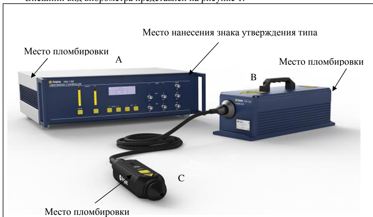
Рисунок 1 - Внешний вид виброметра HSV-100, с двухканальным контроллером (A), сенсорной головкой HSV-I-100 (C) и лазерным модулем HSV-100 (B), схема пломбировки от несанкционированного доступа и место нанесения знака утверждения типа
