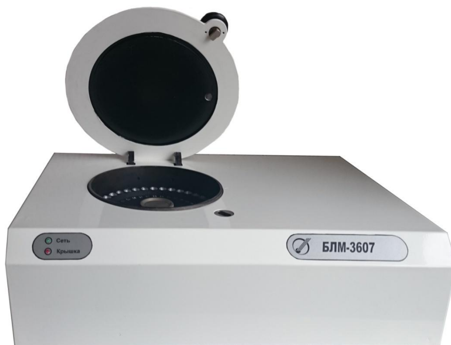
Рисунок 1 - Общий вид анализаторов биохемилюминесцентных БЛМ-3607
