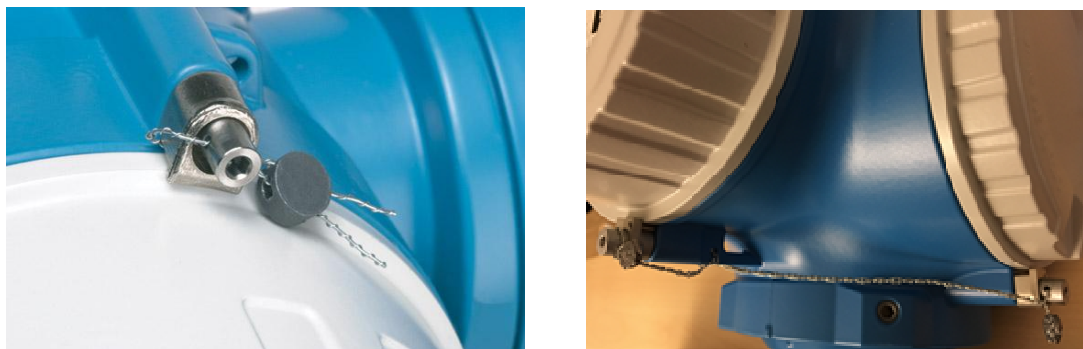
Рисунок 3 - Пломбирование корпуса измерительного преобразователя
