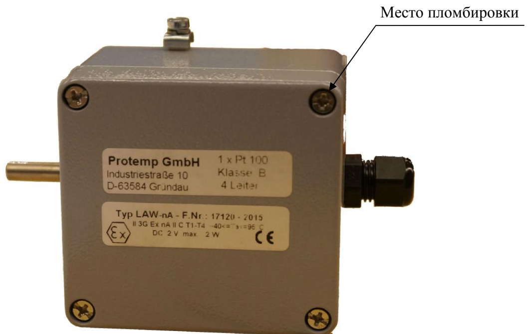
Рисунок 1 - Общий вид термопреобразователя сопротивления платинового LAW-nA с указанием места пломбировки
