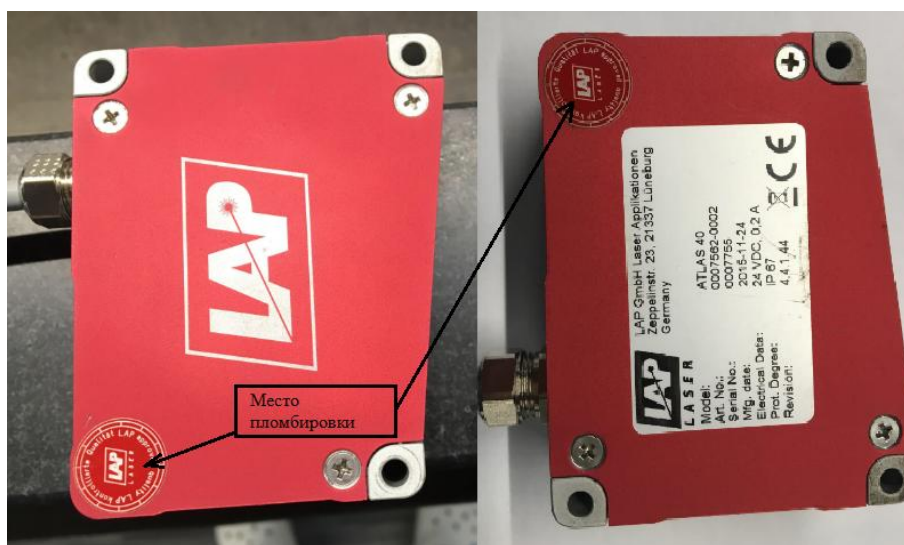
Рисунок 4 - Схема пломбировки датчиков серии Atlas
