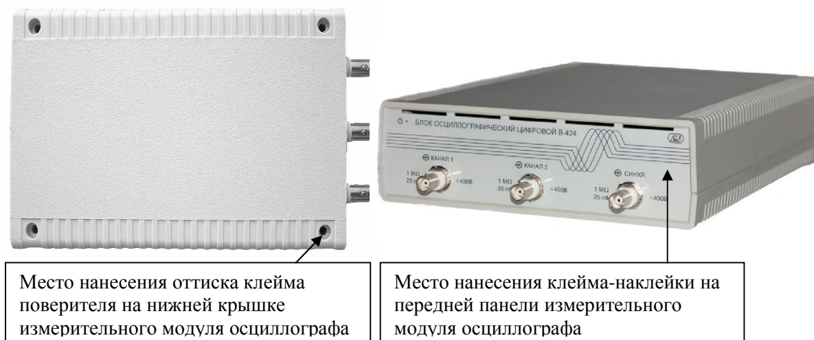
Рисунок 3 - Фотография внешнего вида осциллографов модификаций В-423, В-424
