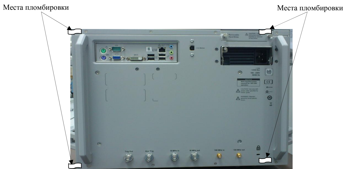
Рисунок 2 - Схема пломбировки от несанкционированного доступа
