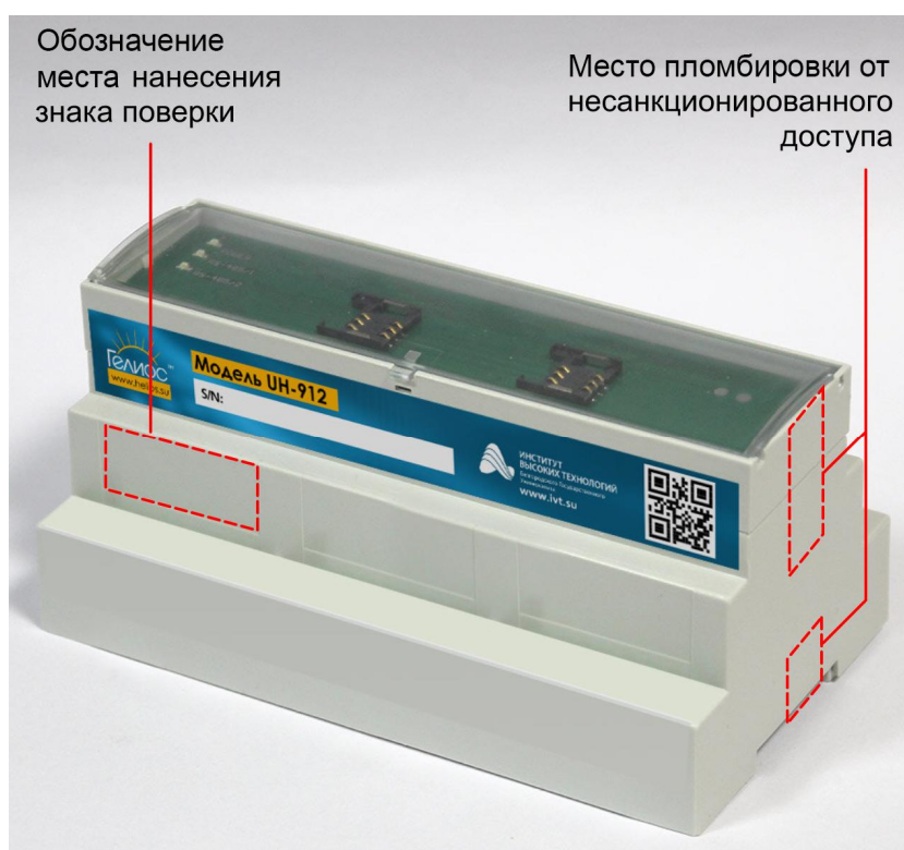
Рисунок 2 - Место пломбировки от несанкционированного доступа и обозначение места нанесения знака поверки
