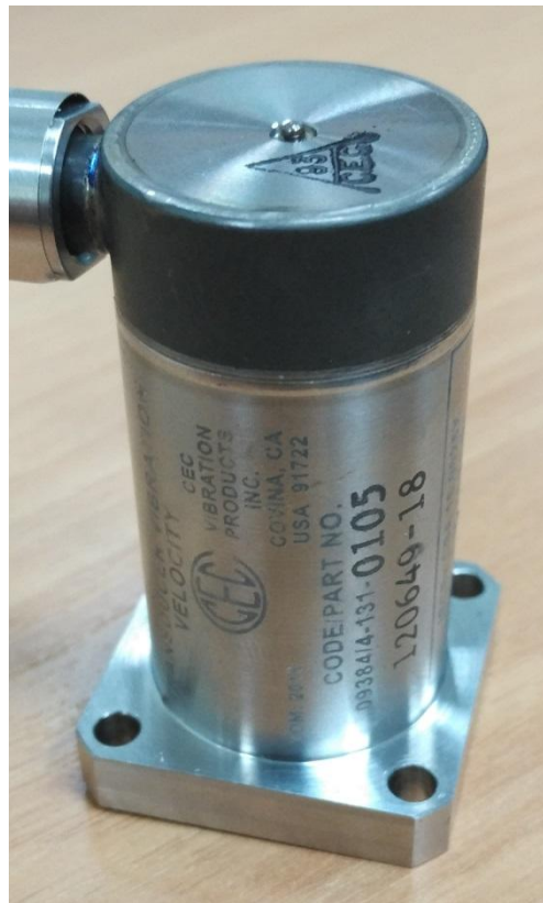
Рисунок 1 - Общий вид преобразователей вибрации 4-131
