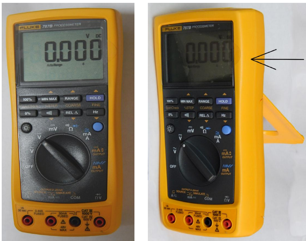
Рисунок 1 – Внешний вид мультиметров. Стрелкой на боковой поверхности показаны места нанесения знака утверждения типа и поверительного клейма.
