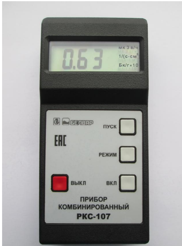
Рисунок 1 – Общий вид прибора комбинированного РКС-107 Пломбирование приборов не предусмотрено.
