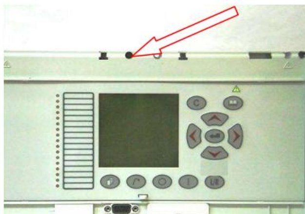
Рисунок 3 – Схема пломбирования контроллеров модификации DS Agile/MiCOM Alstom C264
