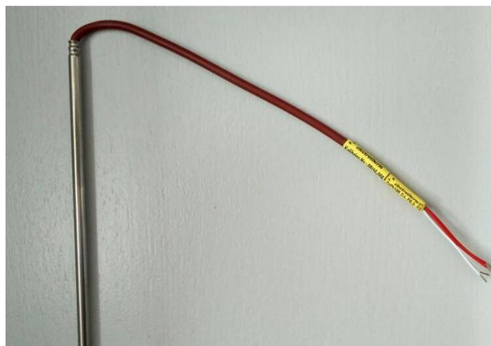
Рисунок 1 - Общий вид термопреобразователей сопротивления платиновых К1W
