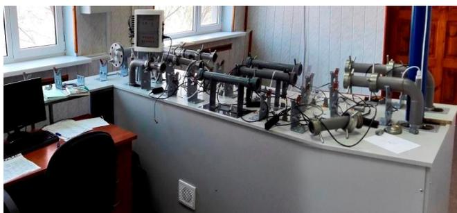
Рисунок 3 – Общий вид установки поверочной АУРС-М модификации АУРС-М-100
