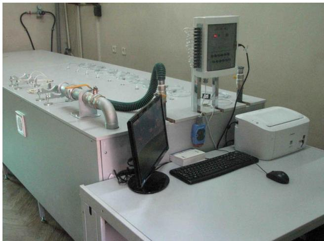
Рисунок 1 – Общий вид установки поверочной АУРС-М модификации АУРС-М-65
