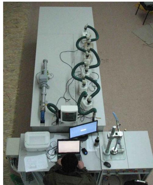
Рисунок 2 – Общий вид установки поверочной АУРС-М модификации АУРС-М-65-Р
