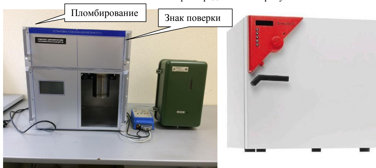
Рисунок 1 - Общий вид комплекса газоаналитического ГНП-1 (слева направо): установка ГНП-У1, аналитический блок, термошкаф Binder.
