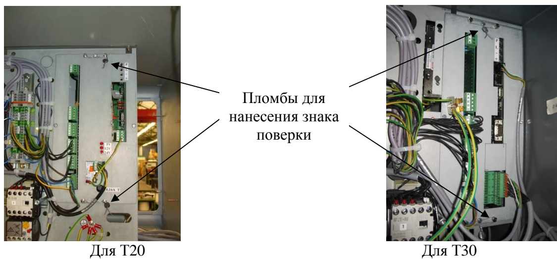
Рисунок 5 - Схема пломбирования крышки электронно-вычислительных устройств Т20 и Т30
