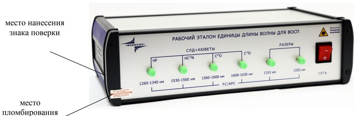
Рисунок 1 – Общий вид эталона со схемой пломбировки от несанкционированного доступа и обозначение места нанесения знака поверки
