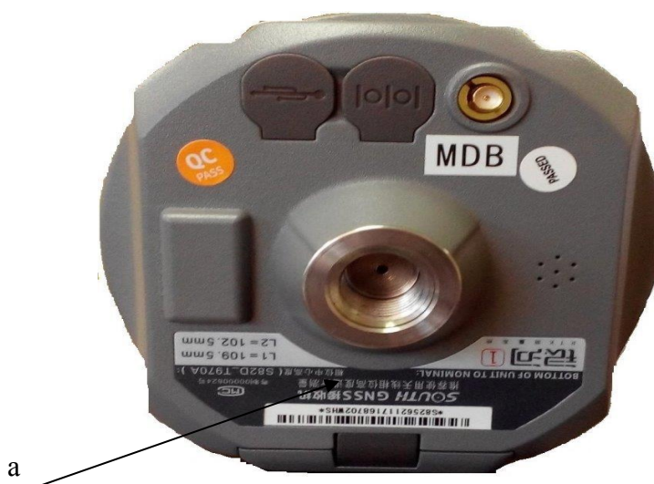
а - место нанесения наклейки со знаком утверждения типа Рисунок 2 - Внешний вид приемников со стороны нижней панели
