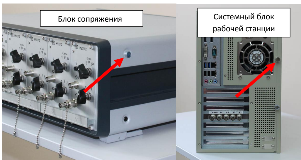
Рисунок 3 - Схема пломбировки от несанкционированного доступа
