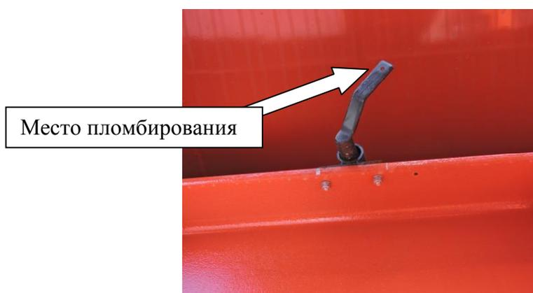
Рисунок 4 - Ручка донного клапана ПЦ и ППЦ
