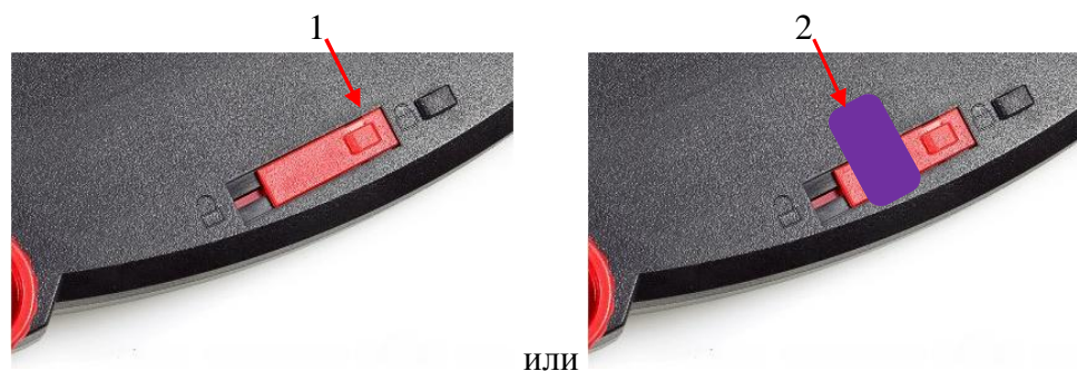
Рисунок 2 - Схема пломбировки от несанкционированного доступа, обозначение места нанесения знака поверки (1 - свинцовая или пластиковая пломба со знаком поверки в виде отиска поверительного клейма; 2 - пломба, знак поверки в виде разрушаемой наклейки)
